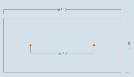
DIAMETRE RONDIN: 120 mm et cordes Ø 22 mm HAUTEUR HORS SOL: 1500 mm. HAUTEUR DES CORDES: 400 et 1430 mm.
