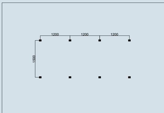
POTEAU SECTION : 90 X 68 mm HAUTEUR DES BARRES : 370 mm.
