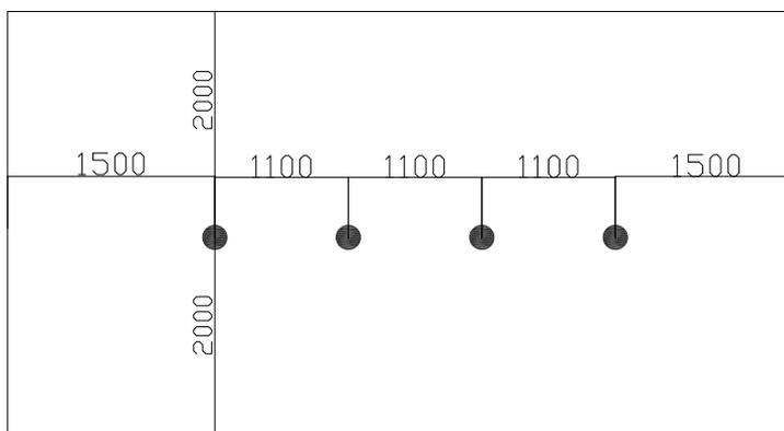
**POTEAU SECTION** : 90 X 90 mm **HAUTEUR DES BARRES** : 1200 ; 1600 et 1800 mm.
